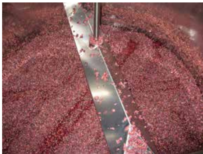
Potopni vinifikator s sietom za odstranjevanje pešk
